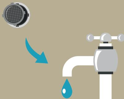
J'installe des mousseurs sur les robinets et dans le pommeau de douche, ils réduisent le débit de 30 % à 50 %, sans perte de confort ni de pression.
