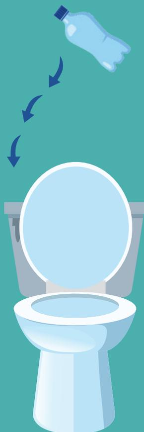
J'équipe mes toilettes d'une chasse d'eau économe ou j'installe une bouteille pleine dans le réservoir de la chasse d'eau pour en limiter le volume.
