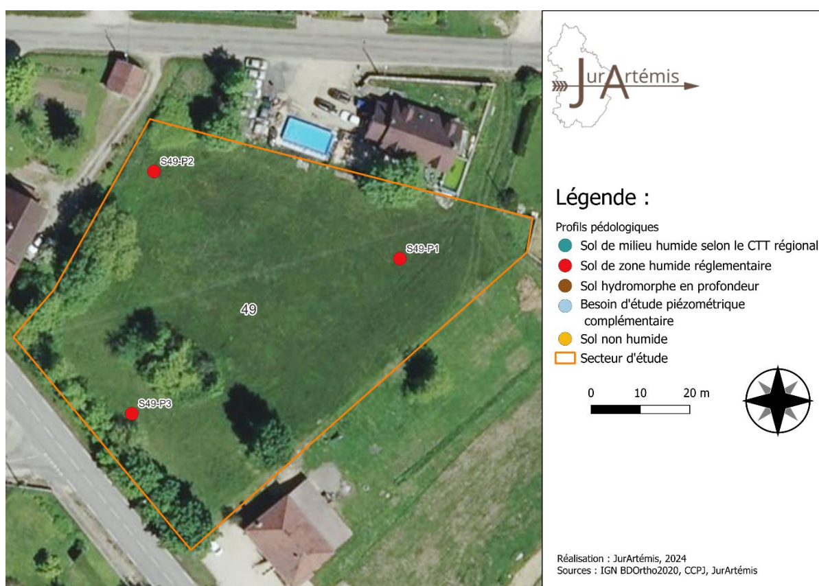
Figure 252. Localisation des sondages réalisés sur le secteur n°49
